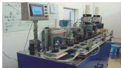
Fan Assembly Line
